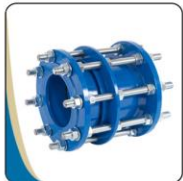
اتصال قابل پیاده شدن فشار کاری: ۱۶ بار سایز: ۵۰ تا ۳۰۰ میلی‌متر جنس: چدن داکتیل
