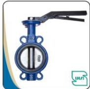
شیر ویفری اهرمی فشار کاری: ۱۶ بار سایز: ۵۰ تا ۳۰۰ میلی‌متر جنس: چدن داکتیل
